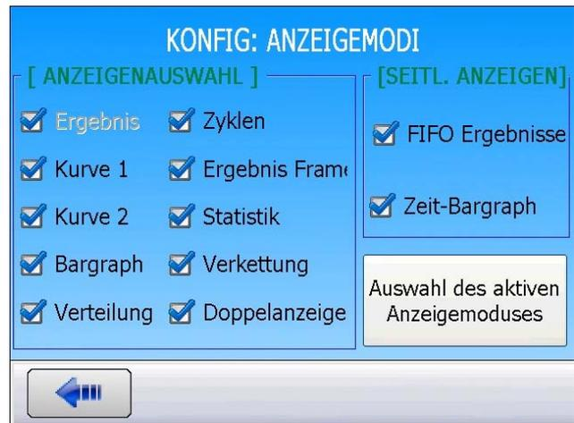
Mit der Schaltfläche Auswahl des aktiven Anzeigemodus rufen Sie das Auswahlfenster der Ansicht auf, die standardmäßig beim Start angezeigt wird.
