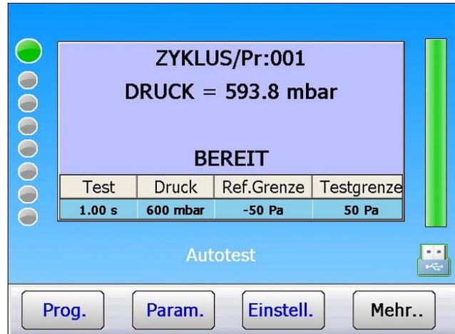
Es werden drei komplette Zyklen mit Füllen, Stabilisieren, Testen und Entlüften durchgeführt.
