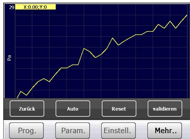
Wählen Sie den Prozentwert für den oberen und unteren Toleranzbereich der Kurve aus (Standardwert +/- 10 %) und bestätigen Sie ihn.
