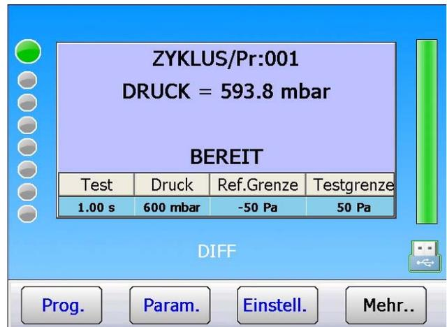
Das Gerät führt eine Entlüftung durch, prüft, ob der Druck null ist, geht anschließend in die Testphase über und zeigt den gemessenen Wert an. Nun kann der Sensor kalibriert werden.
