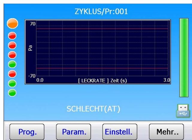
Führen Sie eine Zyklusmessung mit einem Gutteil oder einem Referenzteil durch.
