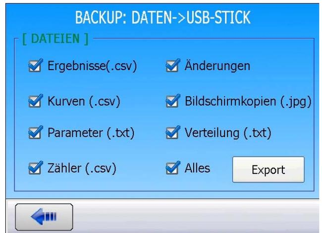
Schließen Sie dann den USB-Stick mit den darauf gespeicherten Bildern an das Gerät an und drücken Sie anschließend unter dem Menü „**Sichern**“ auf die Schaltfläche:
