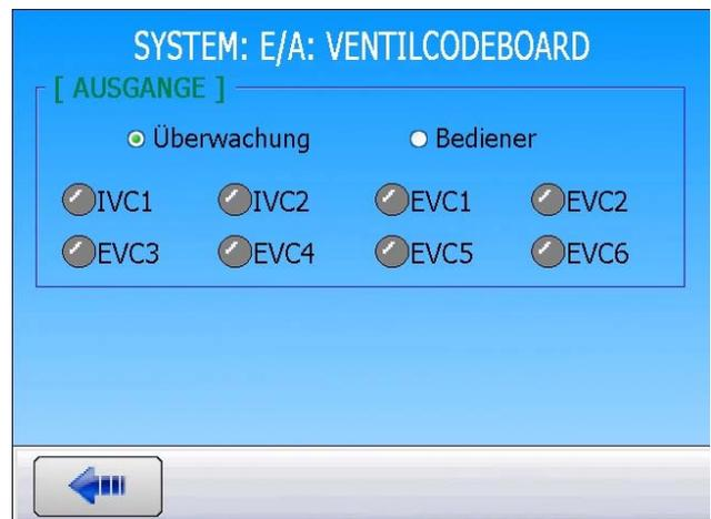
Im Modus **Überwachung**: Der Bediener stellt die Schaltungen der Ein-/Ausgänge durch die SPS und das Gerät fest.
