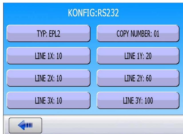
Über die Schaltfläche „**Type: EPL2**“ wird die Druckersprache ausgewählt.
