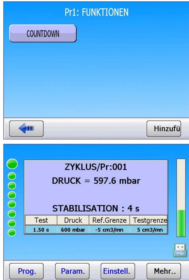
In jeder Stufe des Zyklus (Füllen, Stabilisieren usw.) wird die verbleibende Zeit der betreffenden Phase in Sekunden angezeigt. Im neben stehenden Beispiel für die Phase Stabilisieren bleiben 4 Sekunden bis zu nächsten Stufe.
