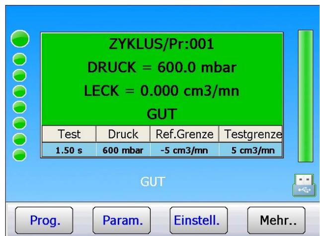
Gehen Sie zu den Programmparametern und prüfen Sie, ob der Wert des Parameters **VOLUMEN** geändert wurde und er mehr oder weniger dem angeschlossenen Volumen entspricht.
