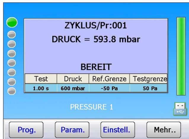
Das Gerät schaltet in den Modus Unendlich Füllen und zeigt den gemessenen Wert an.
