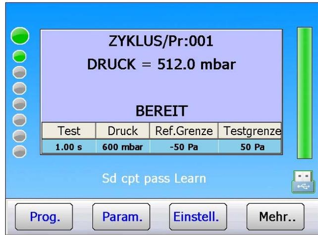
Im Lernzyklus werden folgende Schritte ausgeführt: **VOLUMEN FÜLLEN, VOLUMENÜBERTRAGUNG**, anschließend **PRÜFUNG**.
