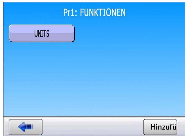
Drücken Sie auf die Schaltfläche „**UNITS: XX**“, um das Einheitensystem zu wählen.
