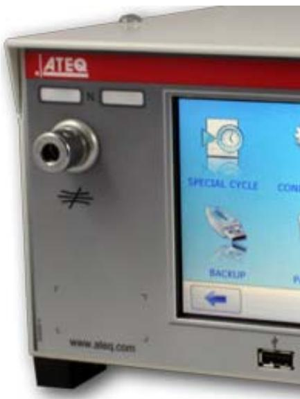
An der Gerätefrontplatte können zwei Schnellanschlüsse eingebaut werden. Diese Anschlüsse vereinfachen die Überprüfung des Drucks und der Kalibrierung. Der erste Anschluss ist für den Reglerkreis. Mit diesem Anschluss kann der vom Gerät angezeigte Prüfdruckwert mit einem Präzisionsmanometer oder dem **ATEQ Leckkalibrator** überprüft werden. Dieser Anschluss ist nicht im Messkreis integriert und beeinflusst nicht die Steuerung.
