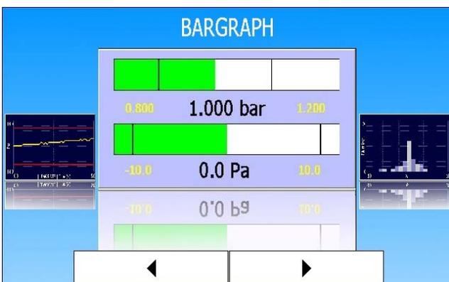
Ansicht „**Bargraph**“: Anzeige der Balkenansicht der Druck- und Leckwerte.
