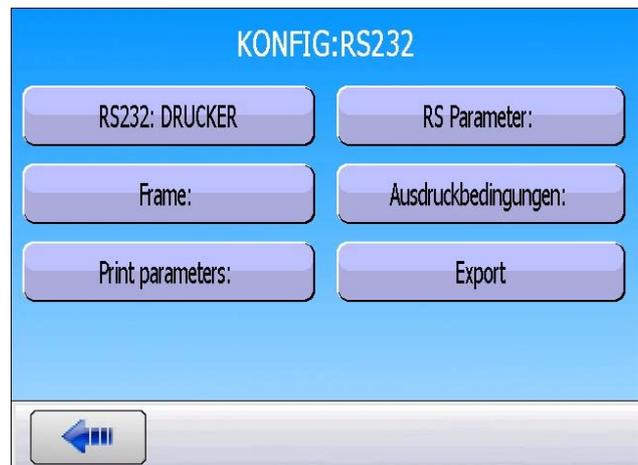
Dieser Frame ist von der gleichen Art wie der Frame für den Parameterausdruck mit der Ausnahme, dass die einzelnen Zeichenketten hintereinander folgen und jeweils durch ein Tabulatorzeichen getrennt sind (TAB = "\t" = 09h), wodurch die einzelnen Zellen in Microsoft Excel automatisch ausgefüllt werden können. Die Frames enden jeweils mit dem Zeichen „0Dh“.
