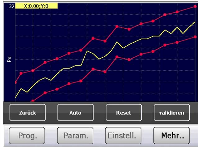
Die Kurven können jederzeit durch Verschieben der Punkte geändert werden. Klicken Sie dazu einen Punkt an und ziehen Sie ihn mit gedrückter Maustaste in die gewünschte Position.
