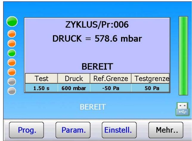
Findet der Spezialzyklus kein passendes Programm für das gemessene Volumen (Programm nicht vorhanden), wird die Fehlermeldung „**Pr Select = FEHLER**“ ausgegeben.
