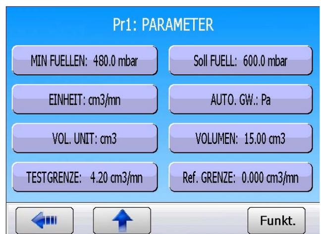
Geben Sie den geschätzten Wert des Volumens des Prüfteils in der zuvor ausgewählten Einheit ein (in unserem Beispiel  $\text{cm}^3$ ) an. Das Volumen entspricht dem internen Volumen des Geräts zuzüglich dem Volumen des Schlauchs und dem Volumen des Teils. Dieses Volumen kann nachträglich korrigiert werden.
