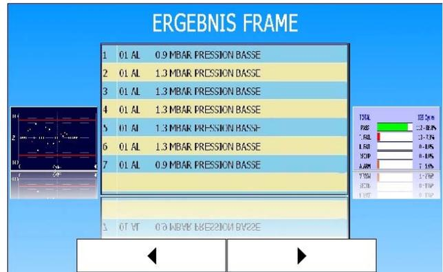
Ansicht „**Ergebnis Frame**“: Anzeige des am Ausgang RS232 ausgegebenen Ergebnisrasters.
