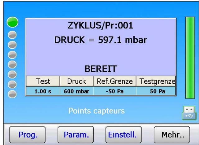
Das Gerät führt eine Entlüftung durch und zeigt die Werte an den Messstellen der einzelnen Sensoren an.
