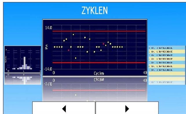
Ansicht „Zyklen“: Jedes Ergebnis wird in Punktform angezeigt. Ermöglicht die Anzeige der Ergebnisse im Verhältnis zu den Ausschussgrenzwerten.
