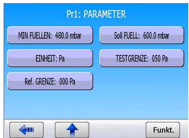
Ändern Sie die Einheit von **Pa** in **cm<sup>3</sup>/min** oder in eine beliebig andere gewünschte Durchflusseinheit.
