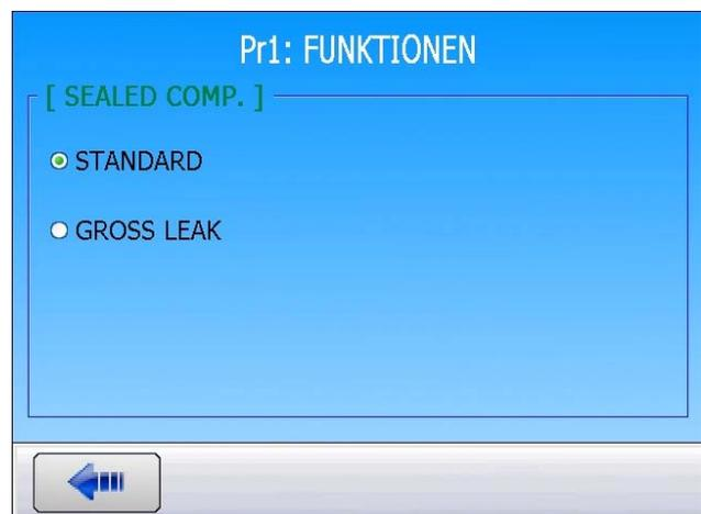
Ist die Betriebsart „Verschlossene Bauteile“ gewählt, werden dem Programm zwei Parameter hinzugefügt: Die Zeit **Fill Volume** und die Zeit **Transfert**, die eingegeben werden müssen.
