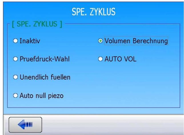
Das Menü für die Parametrierung der Volumenberechnung erscheint. Geben Sie die Parameter **Soll KAL** und **EINHEIT** ein.
