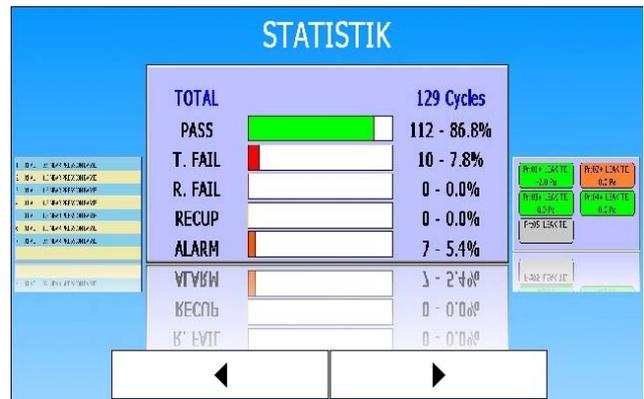
Ansicht „**Statistik**“: Anzeige der Anzahl und des Prozentsatzes der Gutteile, Schlechteile usw.
