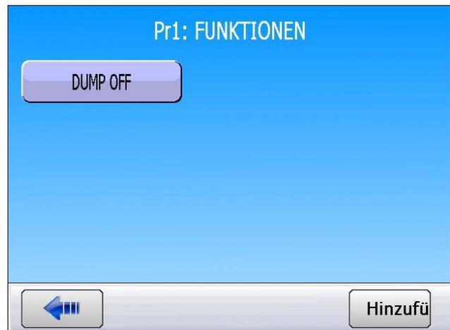
Nach Freigabe der Funktion erscheint die Phase Entlüften nicht mehr unter den Parametern des Prüfprogramms.
