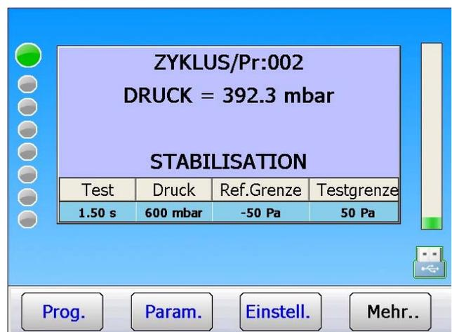
**Hinweis:** Die vom Gerät ermittelten Prüfparameter können zur Optimierung der Zykluszeit geändert werden.
