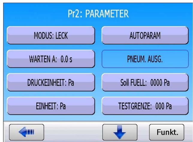
Sind alle Parameter erfasst, drücken Sie die Taste „**START**“. Das Gerät fordert Sie auf, den Druck am Regler einzustellen (bei mechanischem Regler).
