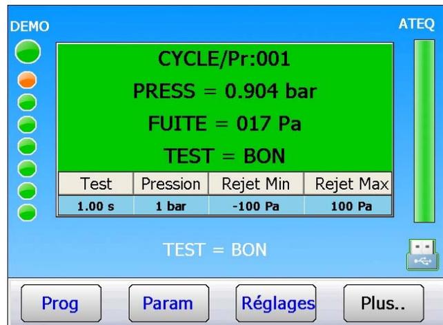
Les paramètres calculés par l'appareil peuvent être consultés dans le menu "**FONCTION/COMP SCELLES**". Ces paramètres peuvent être modifiés par l'utilisateur.
