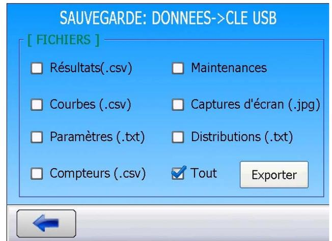
Connecter ensuite la clé USB contenant les images sur l'appareil, puis dans le menu "**Sauvegarde**" appuyer sur le bouton :
