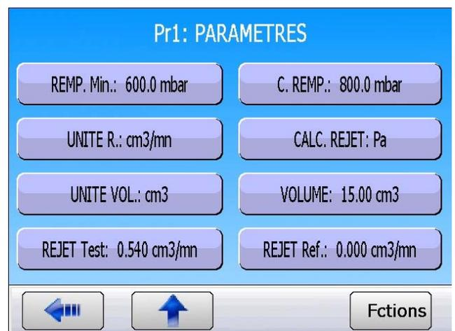
Entrer la valeur estimée du volume de la pièce à tester, dans l'unité précédemment choisie (cm<sup>3</sup> dans notre exemple). Le volume est : le volume interne de l'appareil plus le volume des tuyaux plus le volume de la pièce. Ce volume pourra être réajusté plus tard.
