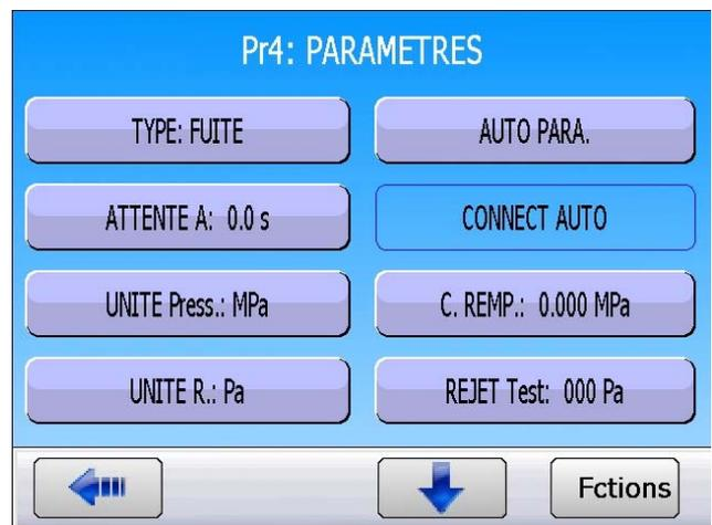
Quand tous les paramètres sont saisis, appuyer sur la touche "**DEPART CYCLE**". L'appareil demande de régler la pression sur le régulateur (cas d'un régulateur mécanique).
