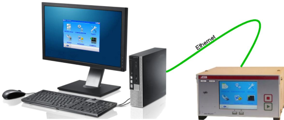
Cette configuration n'est pas très utile, hormis pour la vérification de la communication entre l'appareil ATEQ et l'ordinateur.
