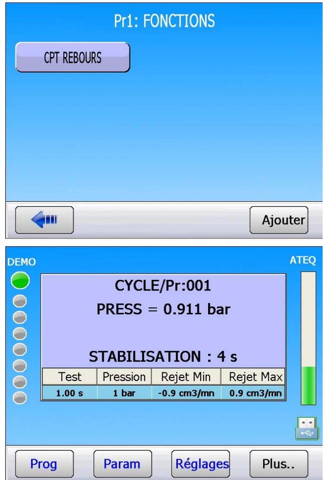
A chaque étape du cycle, Remplissage, Stabilisation, etc. sera affiché en secondes, le temps restant pour l'étape concernée. Dans l'exemple ci-contre, pour l'étape de stabilisation, il reste 4 secondes avant l'étape suivante.
