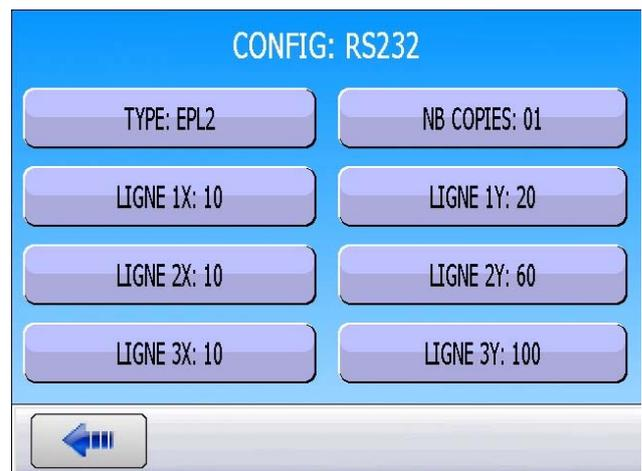
Le bouton "**Type: EPL2**" permet de sélectionner le langage de l'imprimante.
