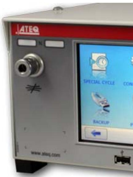
Deux connecteurs rapides peuvent être montés sur la façade de l'appareil. Ils permettent une vérification aisée de la pression et de la calibration. Le premier est utilisé pour le circuit régulateur. Il permet de vérifier la valeur de la pression de test indiquée par l'appareil avec un manomètre de précision ou le **Calibrateur de Fuite ATEQ**. Ce connecteur n'est pas dans le circuit de mesure et ne perturbe pas le contrôle.
