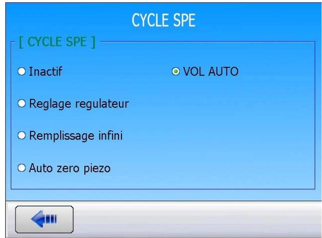
L'appareil confirme que le cycle spécial "VOL AUTO" est sélectionné et prêt à être exécuter.
