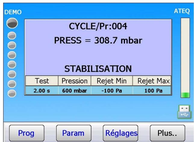
**Note** : les paramètres de tests calculés par l'appareil peuvent être modifiés pour optimisation du temps de cycle.
