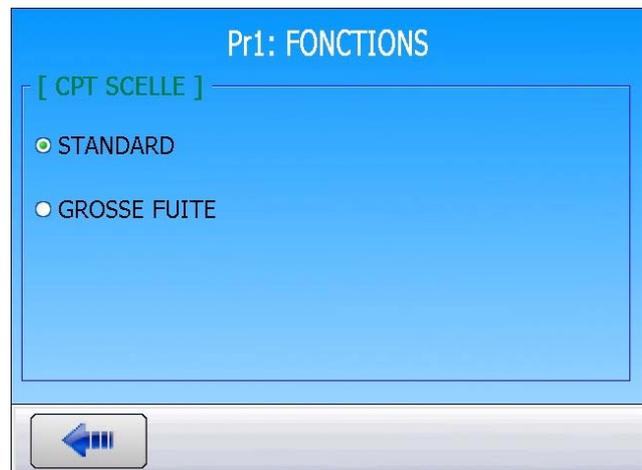
Quand le mode "Composants Scellés" est sélectionné, deux paramètres s'ajoutent au programme : Temps de **Remplissage volume** et temps de **Transfert** qu'il convient de renseigner.
