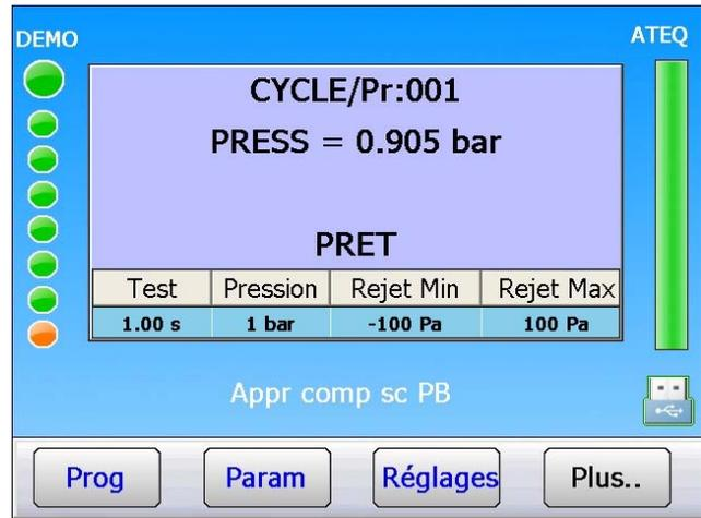
Le cycle d'apprentissage se déroule, avec les étapes : **REPLISSAGE VOLUME**, **TRANSFERT VOLUME** puis le **TEST**.
