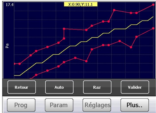
Appuyer sur le bouton **Valider** Pour sauvegarder les points du gabarit. L'appareil vous demande de confirmer, appuyer sur **OK**.
