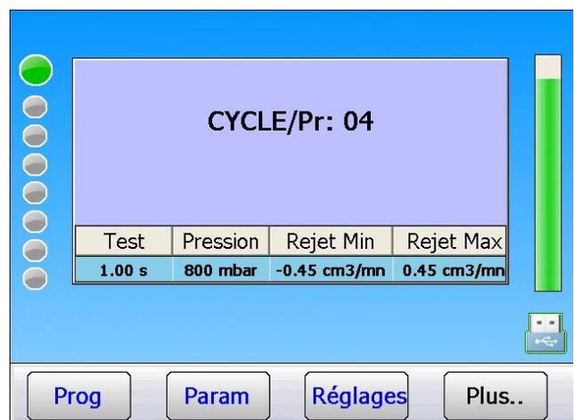
L'appareil se met en attente de départ cycle avec le programme sélectionné, appuyer sur le bouton "**DEPART CYCLE**" pour le lancer.
