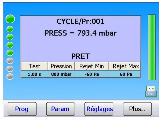
Les phases du cycle sont indiquées en direct sur l'afficheur :
