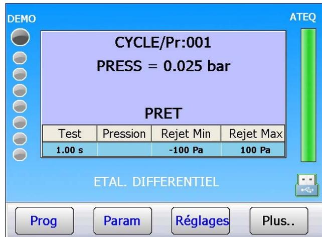
L'appareil exécute un vidage, vérifie que la pression est nulle puis se met en test et affiche la pression mesurée. Un étalonnage du capteur est alors possible.
