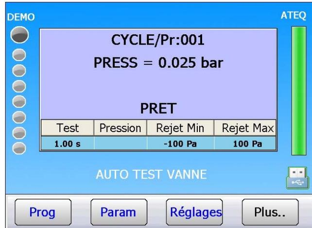
Trois cycles complets de Remplissage; Stabilisation, Test et Vidage, sont réalisés.
