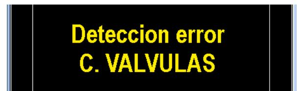
Reinicie el aparato y compruebe si el cabezal de medición arranca (ruido en las válvulas neumáticas).
