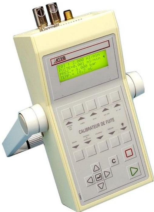
El **calibrador de fugas ATEQ** es un caudalímetro multiescala diseñado para controlar los aparatos de fugas y, en especial, los fabricados por **ATEQ**. Gracias a su sensor diferencial, permite medir las pérdidas de carga en los bornes de un dispositivo deprimógeno calibrado.
