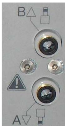
Permite el control neumático de los taponamientos según la presión de la red de alimentación del aparato.
