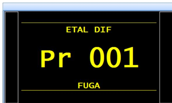
El aparato ejecuta un vaciado, comprueba que la presión sea nula y, a continuación, realiza la prueba y muestra la presión medida. Entonces será posible proceder al calibrado del sensor.
