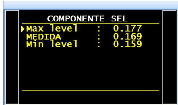
En caso de que previamente no se haya realizado el ciclo especial de los componentes sellados, en la pantalla se mostrará el mensaje de alarma «**Realizar aprendizaje COMPONENTE SELLADO**».
