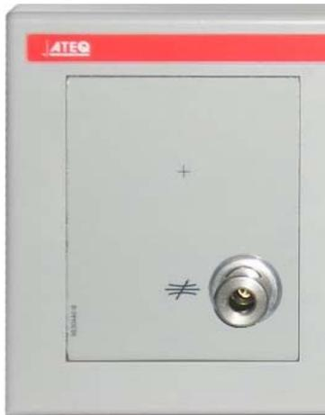
El panel delantero del aparato permite la instalación de un conector rápido para facilitar la verificación de la presión y la calibración. De esta forma, es posible comprobar el valor de la presión de prueba indicado por el aparato utilizando un manómetro de precisión o un **Calibrador de fugas ATEQ**.
