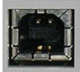
Toma USB para la conexión de un PC.
