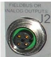
Conecte la alimentación suministrada junto con el aparato. Esta opción no es viable si el conector se utiliza para las redes de campo (Devicenet / Profinet).
