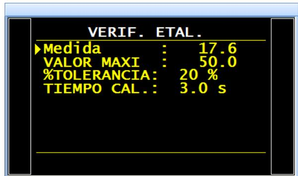
La activación de una alarma indicará que el calibrado no es correcto.
