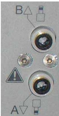
Pour le pilotage pneumatique de bouchonnages à la pression du réseau d'alimentation de l'appareil.
