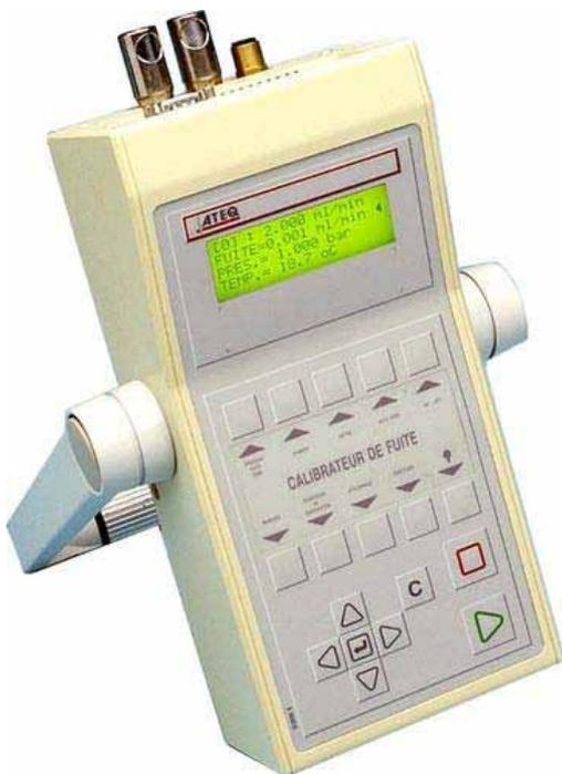
Le **Calibrateur De Fuite ATEQ** est un débitmètre multi-gamme destiné au contrôle des appareils de fuite et ceux d'ATEQ en particulier. Il mesure une perte de charge grâce à un capteur différentiel, aux bornes d'un organe déprimogène calibré.
