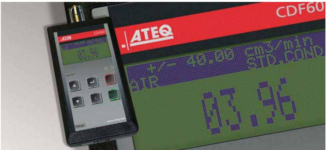
L'appareil **ATEQ CDF60** vérifie la calibration des appareils de mesures de fuites et de débits ainsi que les fuites et rubis étalon.
