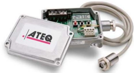
A l'aide de ce capteur de température, l'appareil ATEQ peut évaluer la différence de température entre la pièce et l'environnement ( $\Delta T^\circ$ ) et ainsi déterminer une correction de pression ( $\Delta P$ ).
