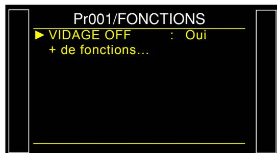
Quand la fonction est validée, l'étape de vidage n'apparaît plus dans les paramètres du programme de test.
