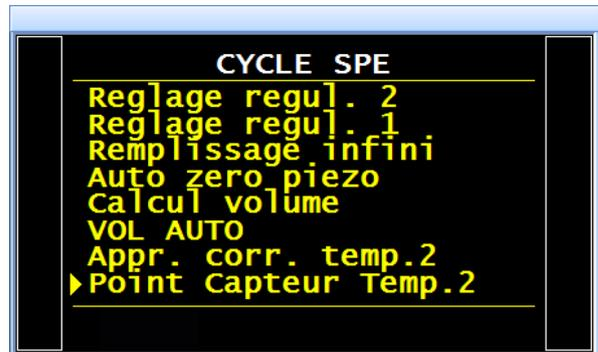
L'écran de cycle s'affiche en confirmant la sélection du cycle spécial "Point. Capteur Temp.2", appuyer sur la touche "DEPART CYCLE"
