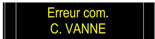
Redémarrer l'appareil, vérifier si la tête de mesure démarre (bruits de vannes pneumatiques).
