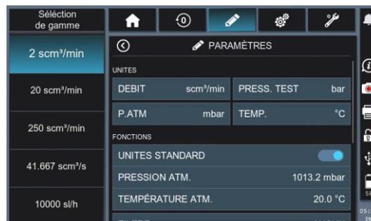
Pour accéder aux paramètres, utilisez la touche paramètres
