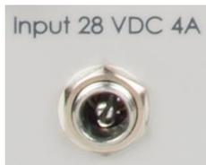
Pour assurer la recharge, l'appareil peut être relié à une alimentation électrique externe (28 V  $\overline{\text{---}}$  4 A), via un connecteur de type Jack 2,5 mm.
